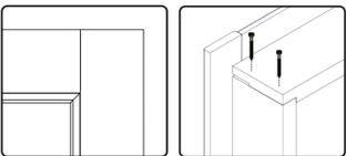
O Sistema Laqueatto Laca 770<sup>®</sup> de fixação é feito com encaixe ombro e fixado com parafusos de forma rápida no próprio marco.
